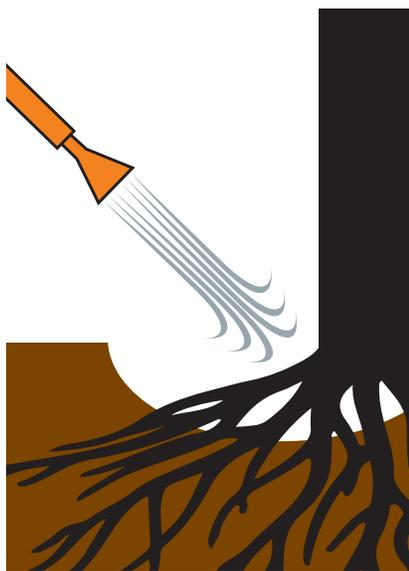
Figure 8. Excavations à l'air
